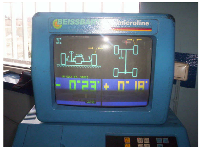
Rys.71. Wartość regulowanego kąta pochylenia koła lewego oraz prawego.
