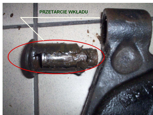
Rys.75. Uszkodzenie wkładu przedniego wahacza lewa strona.
