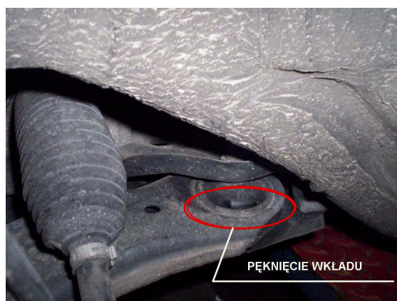
Rys.78. Uszkodzenie wkładu tylnego wahacza lewa strona (kąć pochylenia dodatni).
