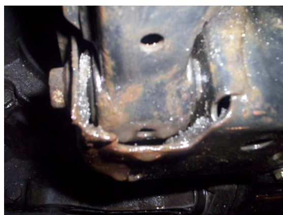
Rys.79. Uszkodzenie wkładu przedniego wahacza lewa strona ; uszkodzenie prawej strony identyczne(kąć pochylenia dodatni).
