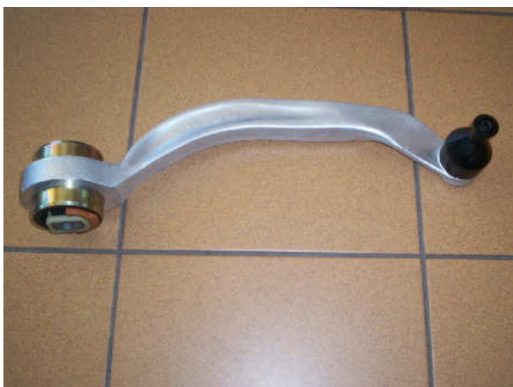
Rys.19. Wahacz poprzeczny skośny przedni (zawieszenie wielowahaczowe) Audi A4.
