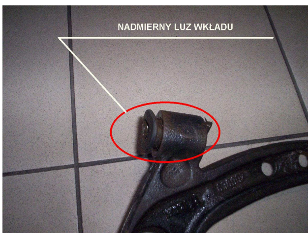
Rys.81. Uszkodzenie wkładu przedniego wahacza lewa strona ; uszkodzenie prawej strony identyczne(kąt pochylenia ujemny).
