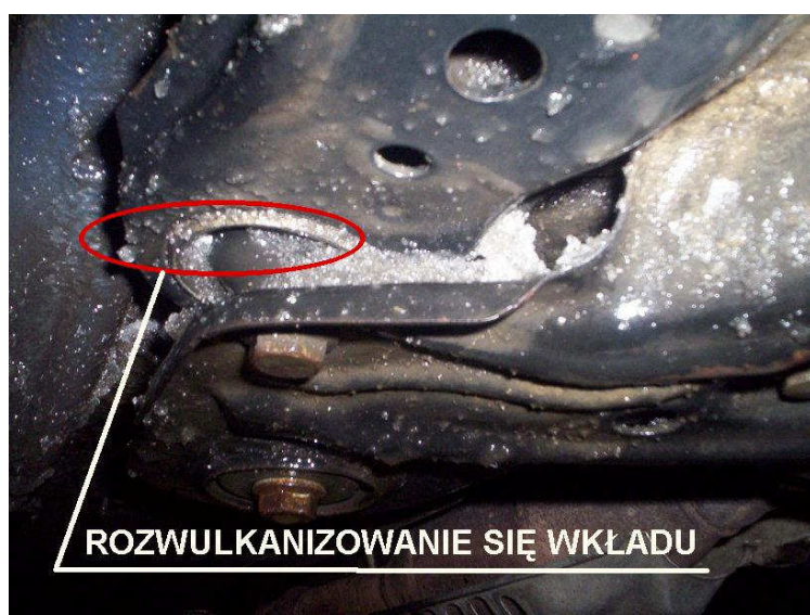
Rys.74. Uszkodzenie wkładu tylnego wahacza przedniego prawa strona.
