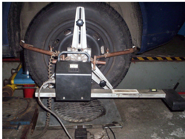
Rys.63. Umieszczenie zacisku mocującego wraz z głowicą pomiarową.
