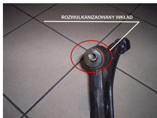
Rys.76. Uszkodzenie wkładu przedniego wahacza prawa strona.
